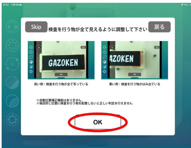
検査対象物が画面内に映るように、検査対象物・端末の位置を調整して下さい。
