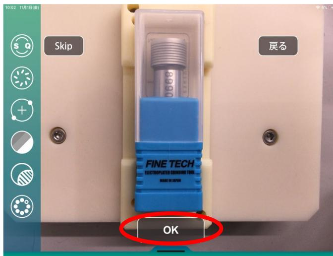
検査項目を設定します。Size検査は、検出したものの面積で合否の判定を行います。
