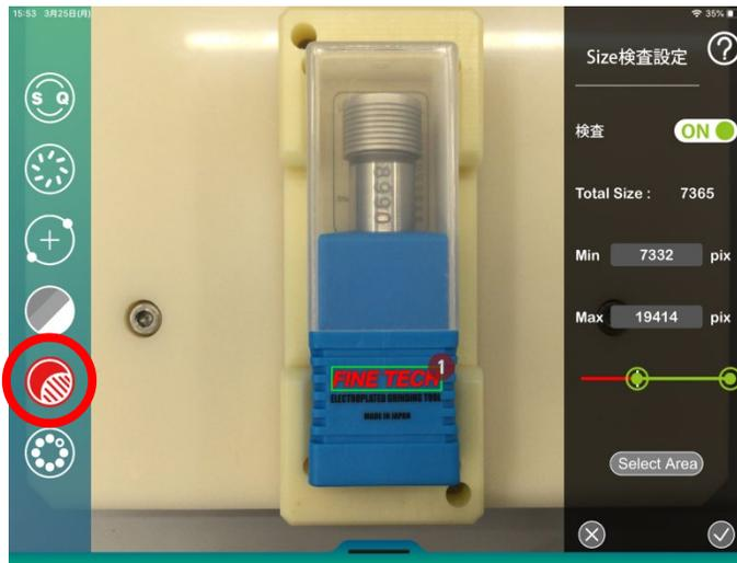
検査： Size検査のON/OFFを切り替えます。
