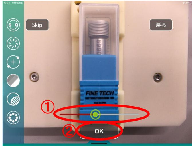
検査を行う範囲を設定します。画面に表示される枠の大きさや位置を変更します。
